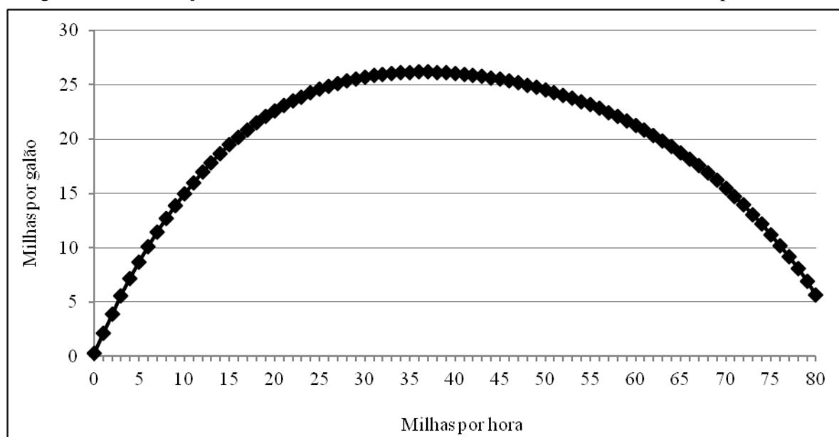
Figura A.8.1 – Relação entre a eficiência do combustível e a velocidade do veículo para o Brasil
